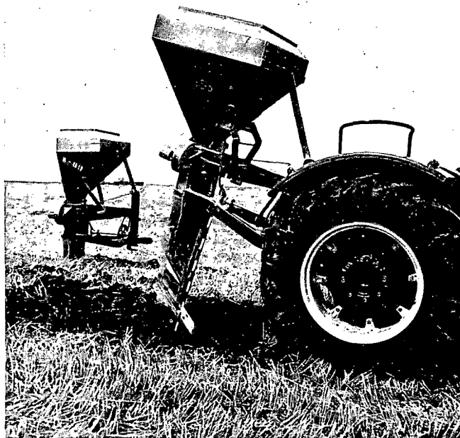
Abb. 15: Das im Jahre 1967 entwickelte und in verschiedenen Größen erstellte Lockerungs- und Tiefendüngungsgerät der Fa. Gnacke u. Braun/Horrem (5158)
