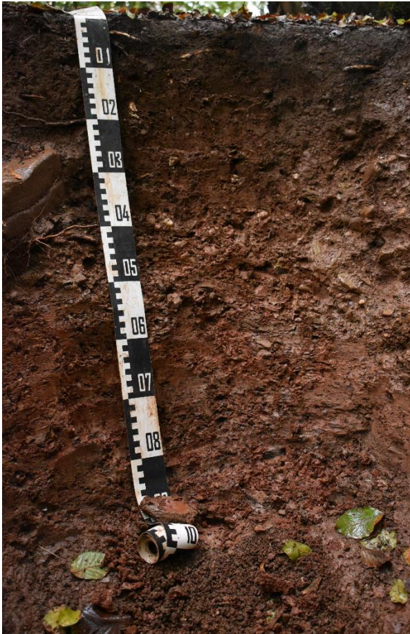
Fig 5: Braunerde-Regosol (Ah - rAp – II Bv- iICv – III iICv) aus flachem Kies führendem Lehm (aus Terrassenkies und Lösslehm) über Kieslehm (aus Lösslehm und Terrassenkiesen) über Schlufftongrus (aus Tonschiefer)
