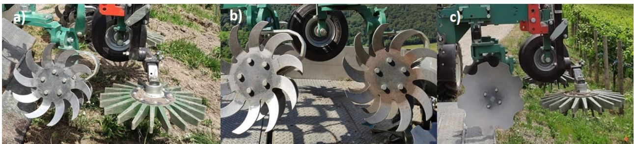
Fig. 13: Unterstockbearbeitungsvarianten a) Rollhacke/ Fingerkralle, b) Rollhacke/ Rollhacke, c) Scheibenegge/ Fingerkralle.
