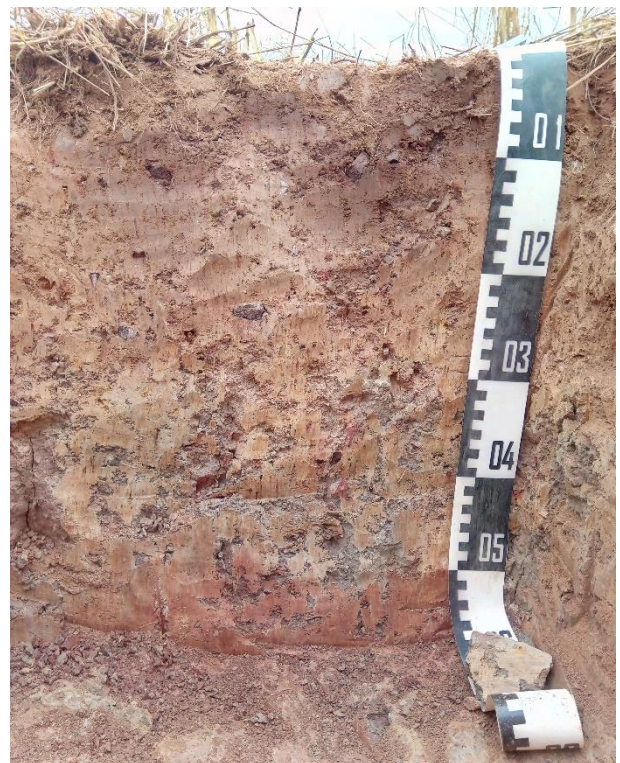
Fig. 6: Primärer Braunerde-Pseudogley aus lösshaltiger Fließerde über Rotliegendem unter Dauerkultur (Durchwachsene Silphie; Silphium perfoliatum )
