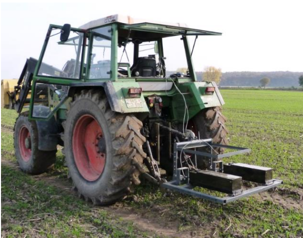
Fig. 12: Gamma-Spektrometer der Bonner Bodenkunde mit zwei 4,2 L-NaI-Kristallen im Schlepperanbau.
